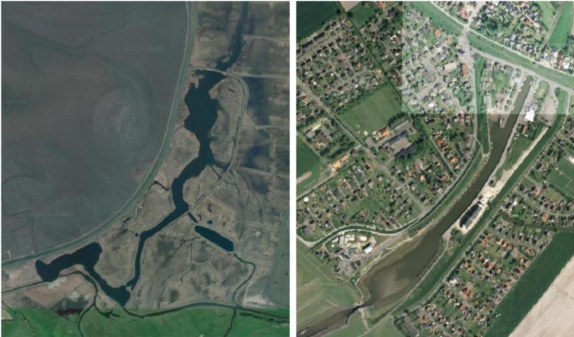
**Abbildung 3-11: Speicherflächen beim Schöpfwerk Steertloch (links) und Speicherfläche beim Kleinschöpfwerk Friedrichskoog-Spitze (rechts).**
