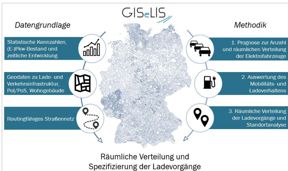
Abbildung 28: Funktionsweise des Standortmodells GISeLIS
