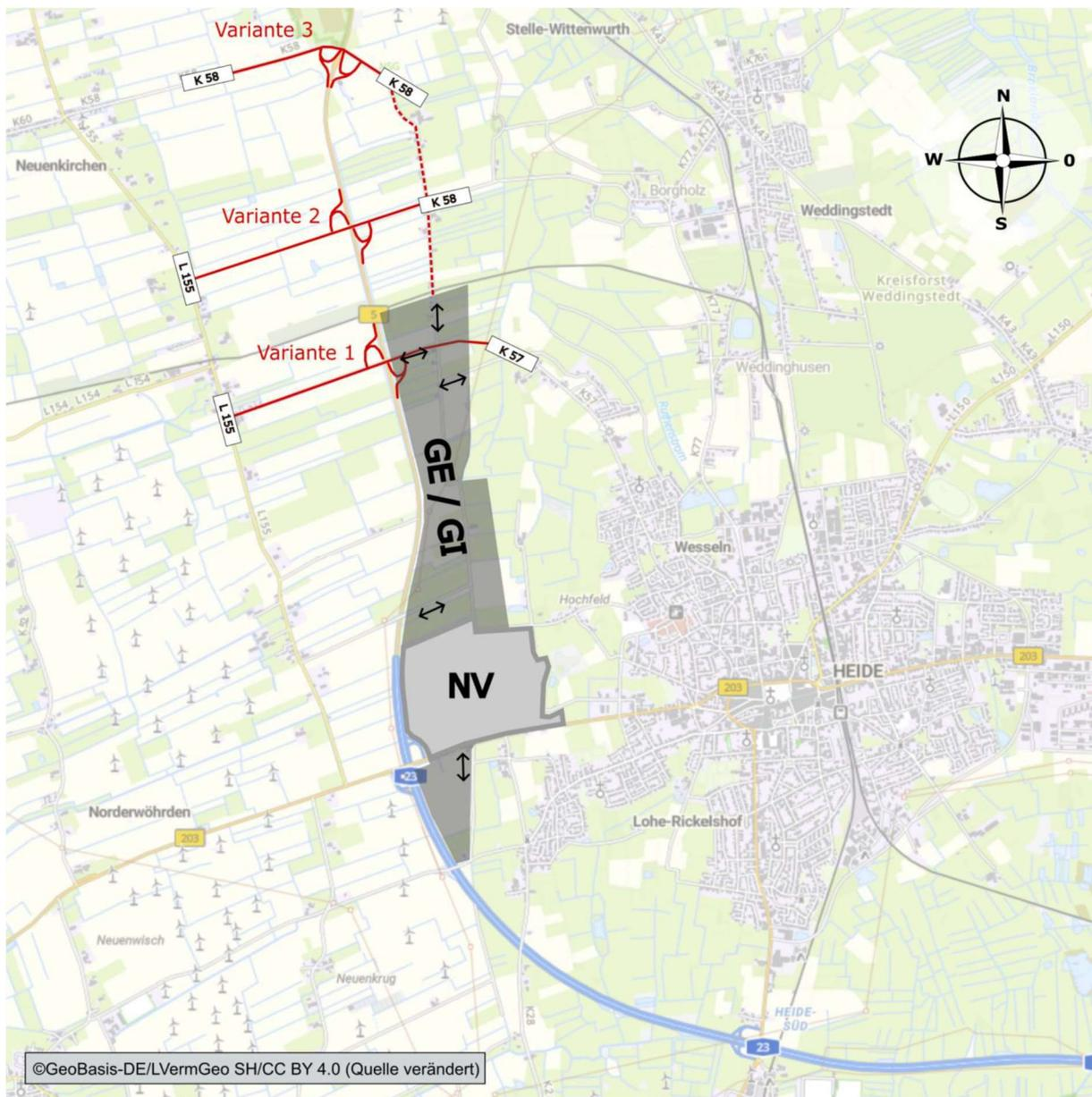
Abbildung 21: Darstellung einer Auswahl möglicher Anschlusspunkte einer neuen Anschlussstelle (Wasser- und Verkehrs-Kontor GmbH 2023)
