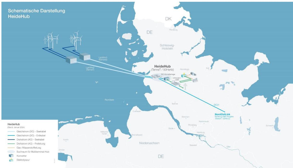
Abbildung 5: Schematische Darstellung des Multi-Terminal-Hubs (Tennet 2023)
