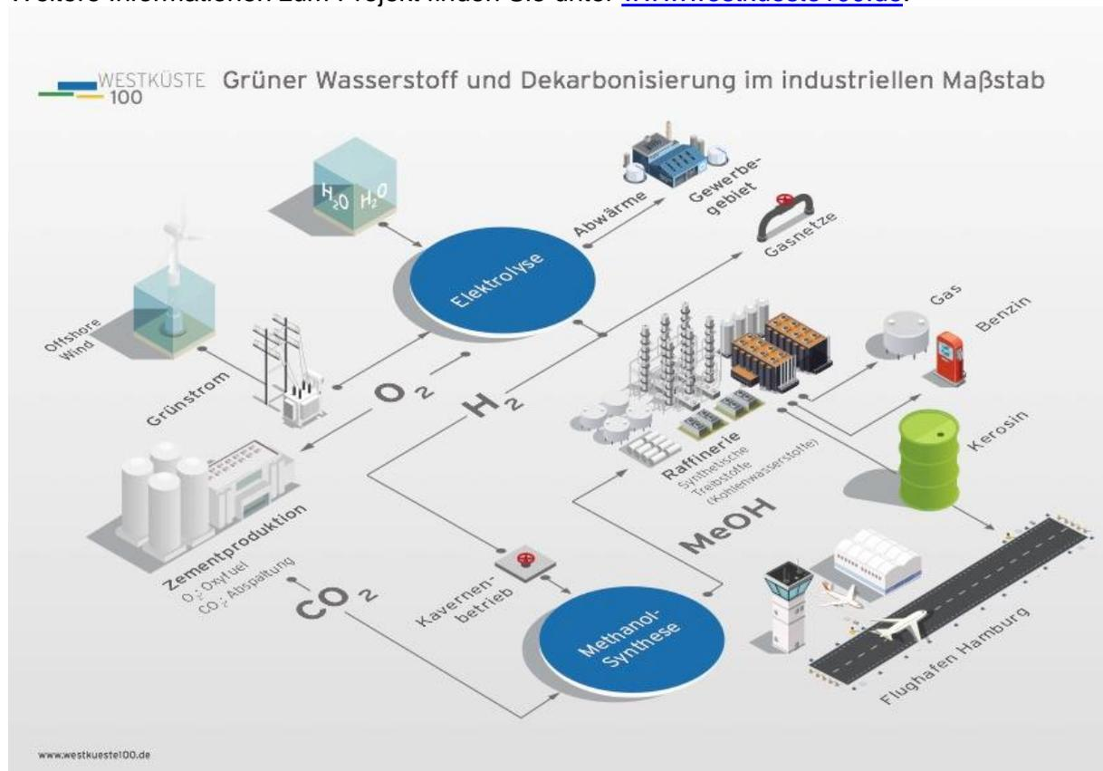
Mit Windkraft grünen Wasserstoff in grüne Kraftstoffe umwandeln und bei der Treibstoffproduktion CO<sub>2</sub> aus der Zementproduktion nutzen
