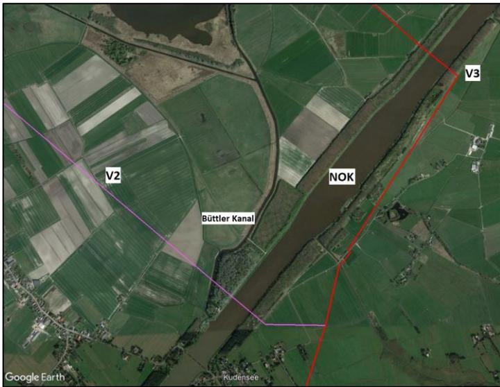
Im Fall der Variante V3 sind sowohl eine offene Querung, d. h. mittels frei verlegtem Düker, als auch eine geschlossene Querung, d. h. mittels HDD-Verfahrens, Pressverfahrens oder mit Hilfe eines Microtunnels, technisch machbar.
